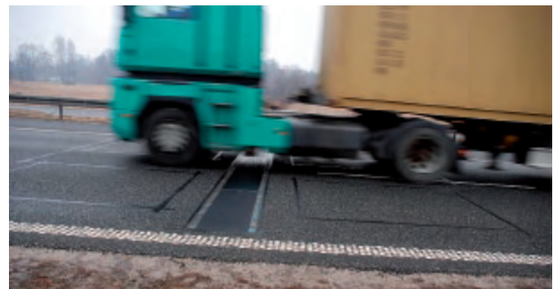
Rys. 4. Przykład płyty ważącej. Fig. 4. Bending plate scale
