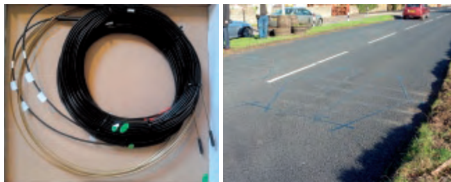
Rys. 2. Polimerowy czujnik piezoelektryczny Fig. 2. Piezo polymer sensor
