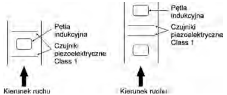
Rys. 3. Przykładowe możliwości montażu [7, 10] Fig. 3. Polymer sensors – example of mounting [7, 10]
